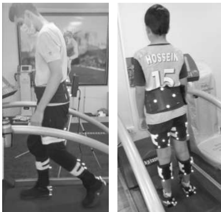
شکل ۳. داده برداری استاتیک و دینامیک از راه رفتن افراد روی تردمیل
