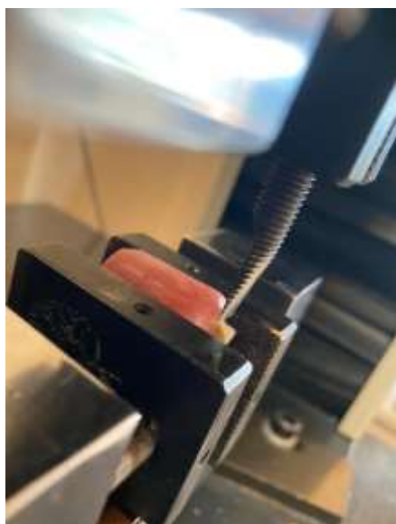
شکل ۳. اندازه گیری استحکام باند برشی در دستگاه تست یونیورسال
