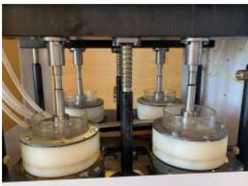
شکل ۲. انجام سایکلینگ در دستگاه لود سایکلینگ
