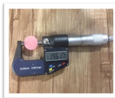
شکل ۱. اندازه گیری ابعادی نمونه‌ها با استفاده از میکرومتر
