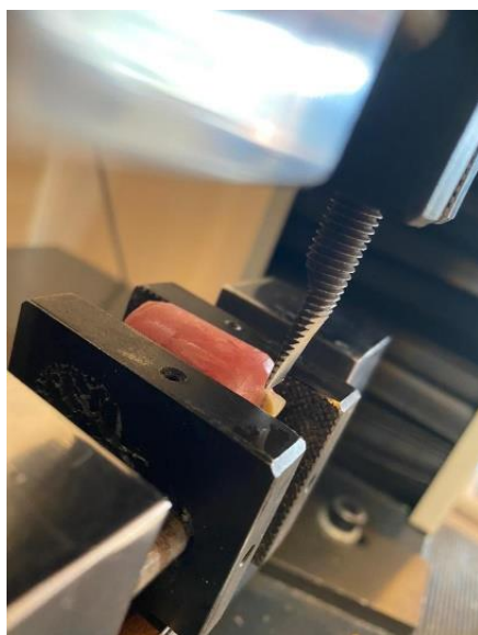
شکل ۳. اندازه گیری استحکام باند برشی در دستگاه تست یونیورسال SANTAM
