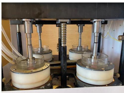
شکل ۲. انجام سایکلینگ در دستگاه لود سایکلینگ
