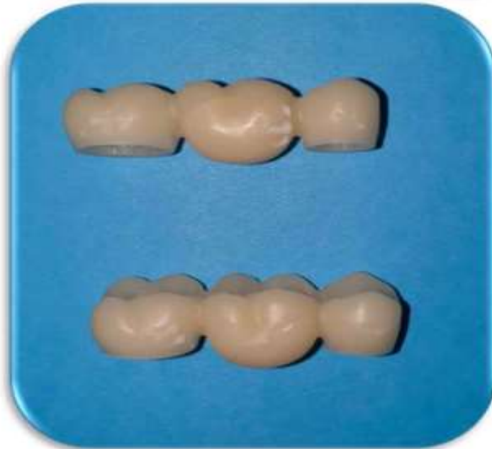
تصاویر رستوریشن های موقت گروه Milling پس از آزمون استحکام خمشی و نحوه شکست
