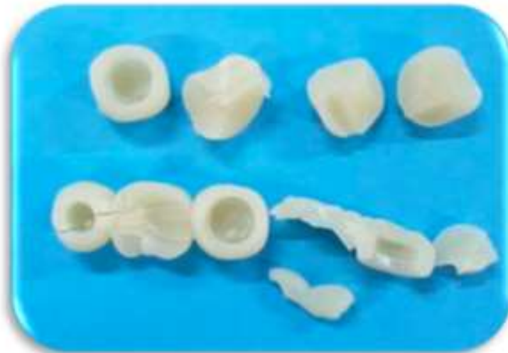
تصویر رستوریشن های موقت گروه پریتتر سه بعدی صفر درجه پس از آزمون استحکام خمشی و نحوه شکست
