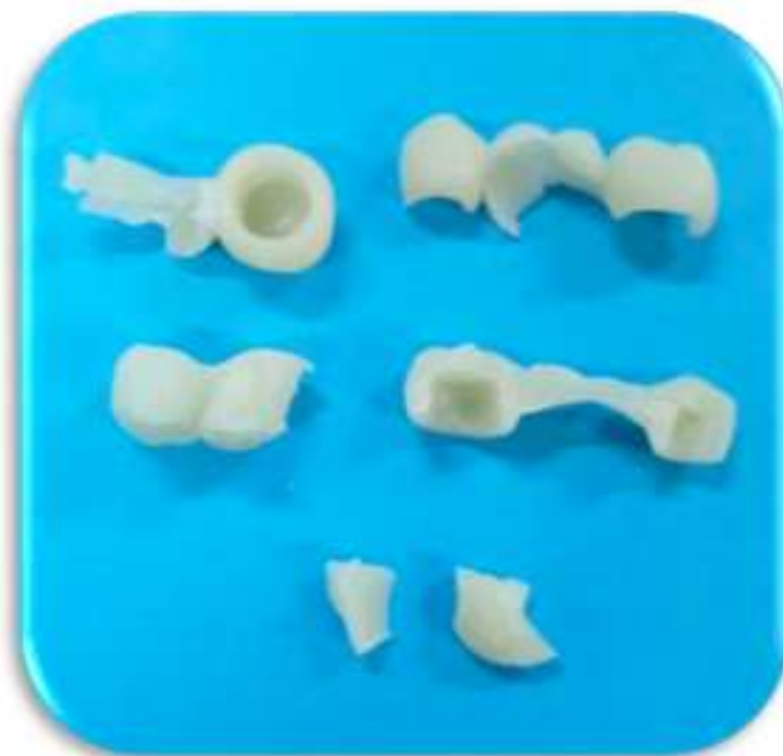
تصویر رستوریشن های موقت گروه پرینتر سه بعدی ۹۰ درجه پس از آزمون استحکام خمشی و نحوه شکست
