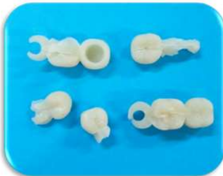
تصویر رستوریشن های موقت گروه پریتتر سه بعدی 15 درجه پس از آزمون استحکام خمشی و نحوه شکست
