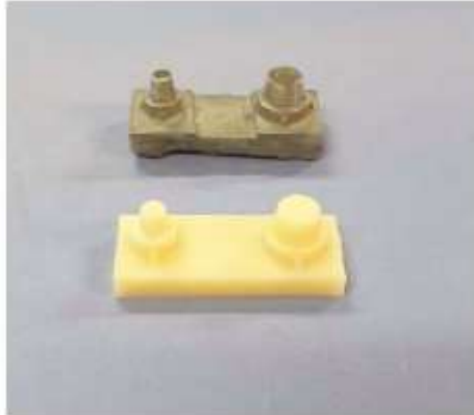
شکل ۴. مدل اصلی از جنس PMMA و مدل فلزی که در آزمایش استحکام خمشی سه نقطه ای استفاده شد
